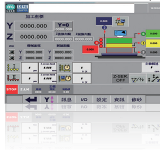
工件研磨條件尺寸設定與上下進給資訊 (可分粗磨、細磨、零研磨設定)
