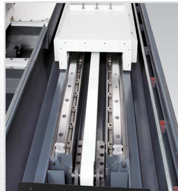
X軸直結式傳動機構，搭配精密級高剛性滾柱型線軌(可選配皮帶式傳動)
